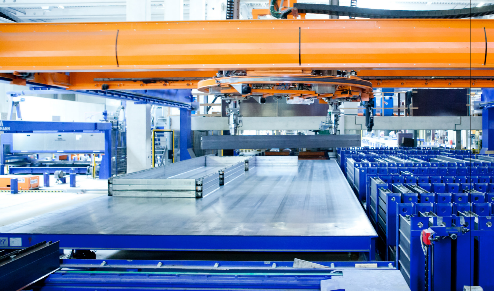
Bild: Vollautomatischer Schalungstisch der Wandumlaufanlage im FBW-Werk Dormettingen
