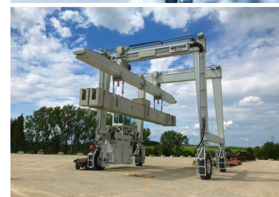
Bild: Shuttellifter im Betonfertigteilelager
