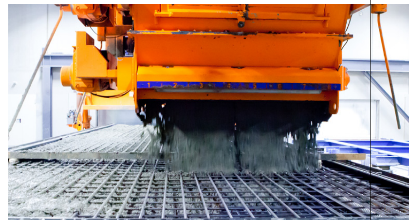
Bild: Halbautomatischer Betonier- und Rütteltisch, WUA bei FBW in Dormettingen
